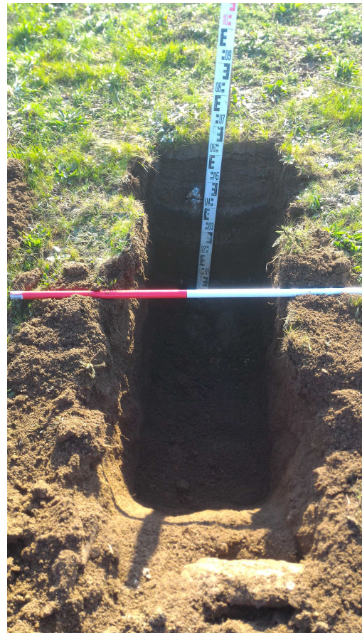
Photo du sondage de sol et test Porchet K2
