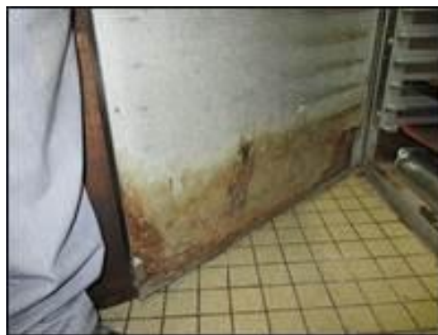
Corrosion du four pâtissier – pâtisserie Chevy
