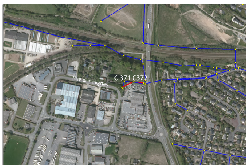
Figure 42 : Canalisations à renforcer – rue des Alignés
