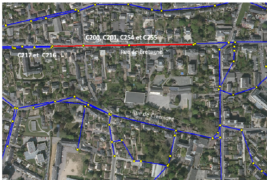
Figure 40 : Canalisations à renforcer – rue de Bretagne
