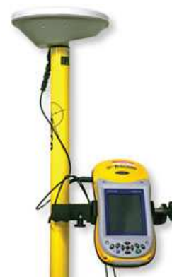
Figure 19 : GPS servant aux levés topographiques
