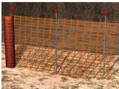
Figure 36 : Principes de clôture de mise en défens à mettre en place.
