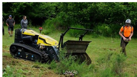
Figure 35 : Principe de débroussaillage centrifuge et exemple de robot débroussaillieur (source : OAgri).
