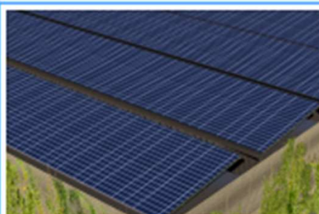
Panneaux photovoltaïques en toiture : Site en autoconsommation 4 106 m 2 d'emprise projetée Hauteur égout : +16m Hauteur faîtiage : +16,55 Pentes de 9%, orientées Sud-Est
