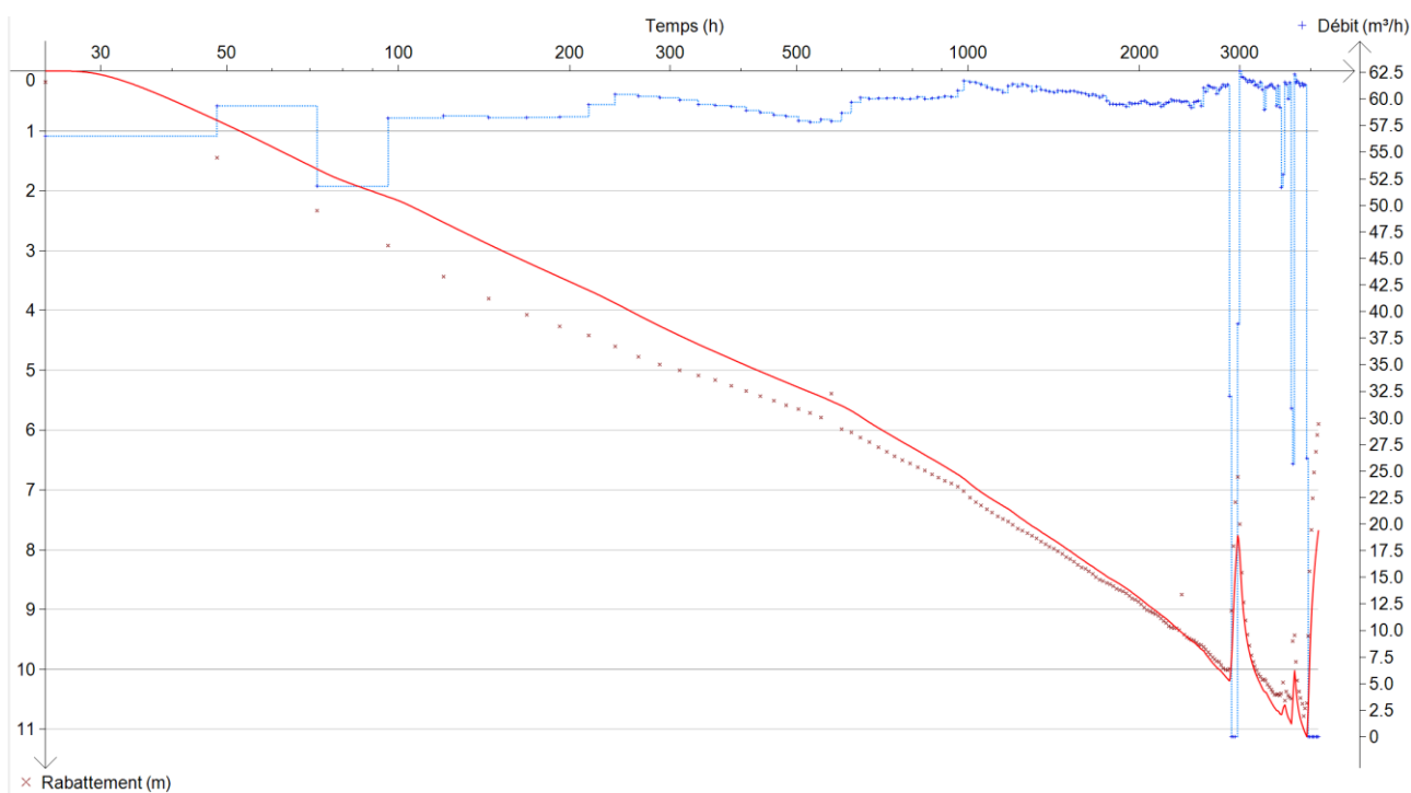
Figure 39 : Ajustement de la solution de Theis en semi-log dans le piézomètre Pp3
