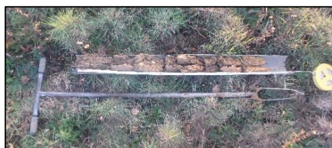
Sondage n°2 : Horizon rédoxique à 0,55 m de profondeur
