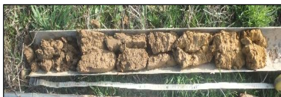
Sondage n°91 : Horizon rédoxique à partir de 0,85 m de profondeur
