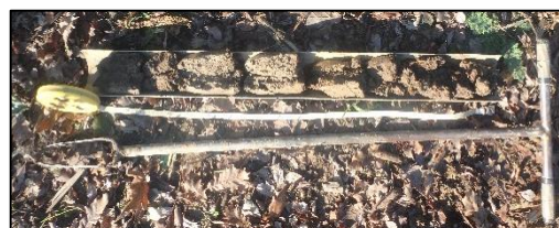
Sondage n°85 : Horizon rédoxique dès 0,10 m de profondeur
