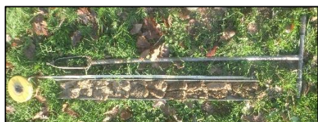
Sondage n°20 : Horizon rédoxique à 0,65 m de profondeur
