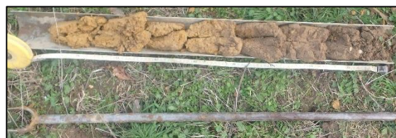
Sondage n°104 : Horizon rédoxique à 0,80 m de profondeur
