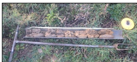
Sondage n°10 : Horizon rédoxique dès 0,20 m de profondeur
