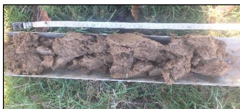
Sondage n°38 : Horizon rédoxique absent, refus à 0,45 m de profondeur
