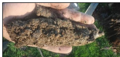
Sondage n°29 : Horizon rédoxique dès 0,15 m de profondeur
