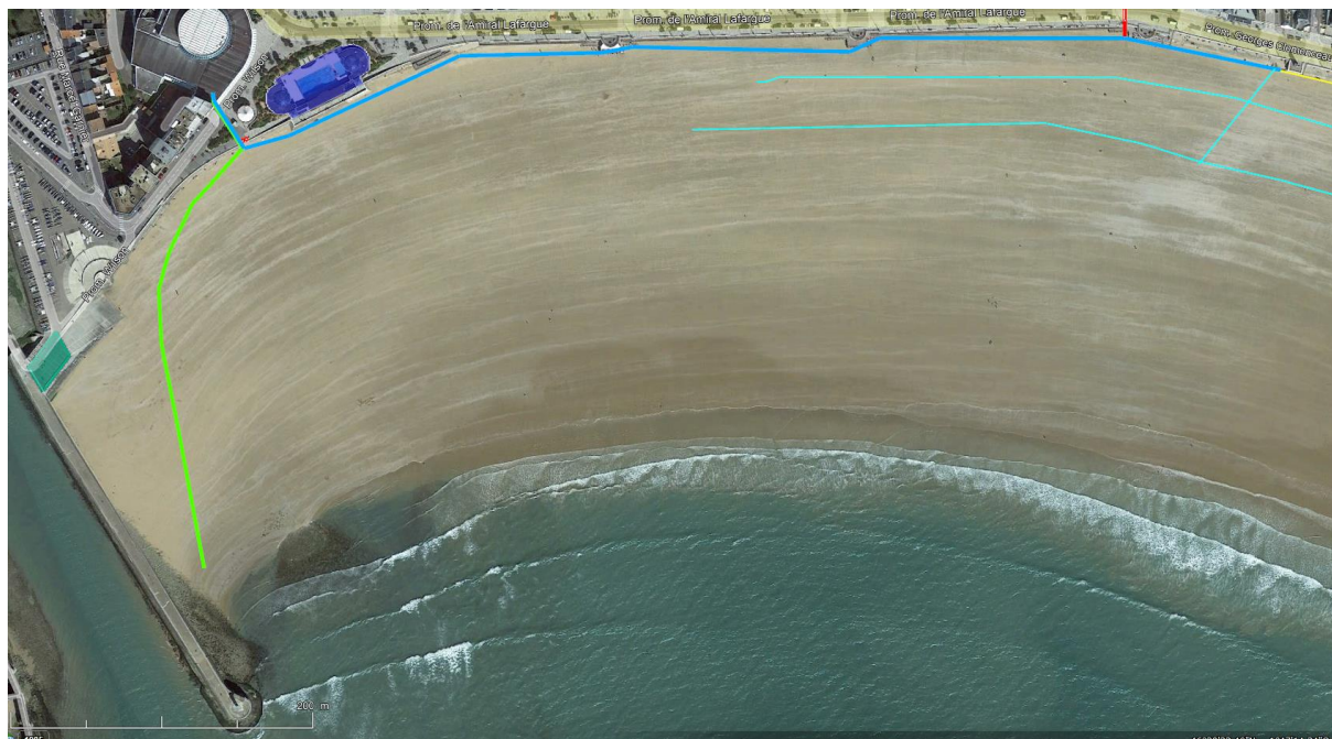
Figure 12 Nouveau refoulement d'eau de mer et exutoire (bleu foncé et vert)
