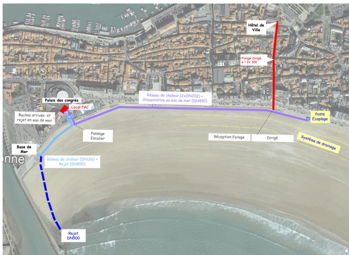
Figure 9 Phases des travaux sur l'estran (Annexe 3)
