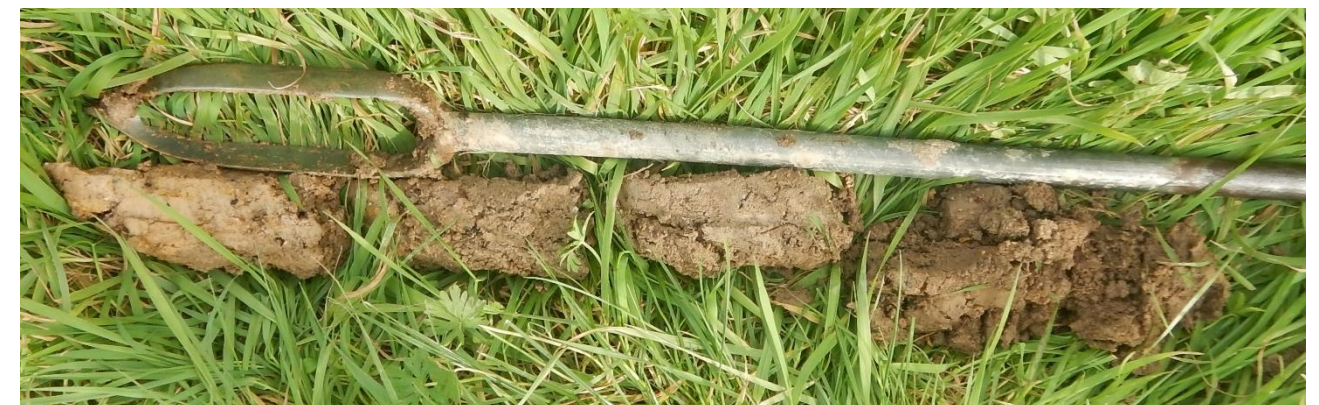
Photo 1 : Exemple de sondage pédologique réalisé avec une hydromorphie à partir de 50cm de profondeur
