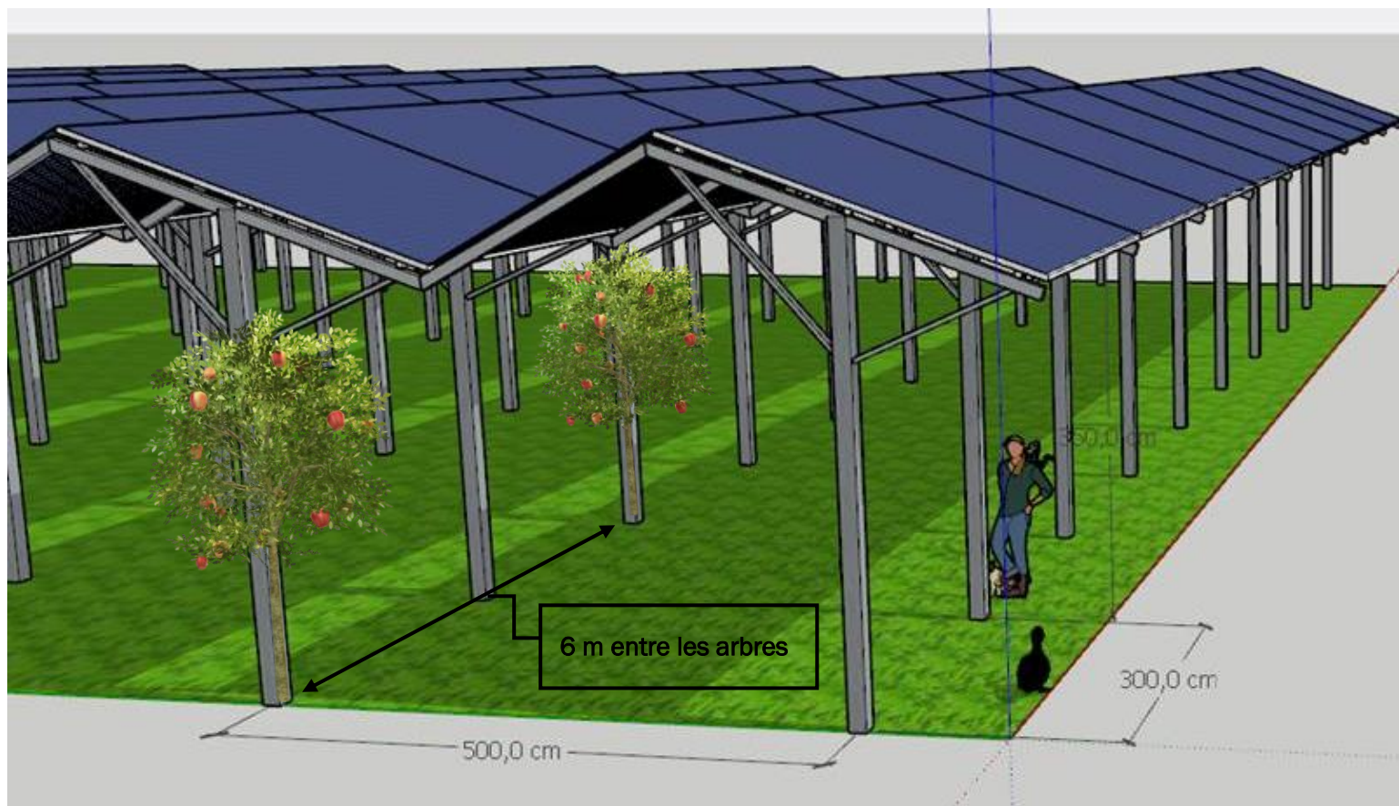
Figure 25 : Modélisation 3D de la volière photovoltaïque, vue du dessus (source : Amarenco/ AA+)
