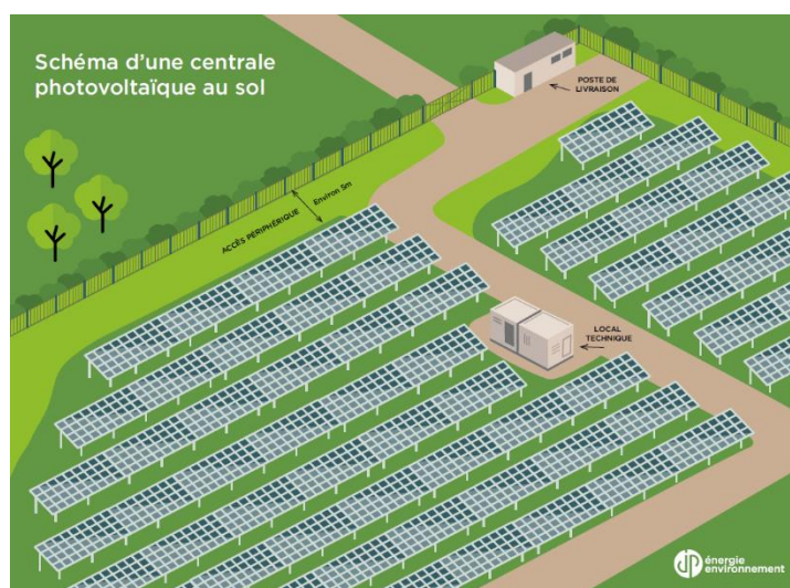
Figure 10 : Schéma d'une centrale photovoltaïque au sol (source : JPee)
