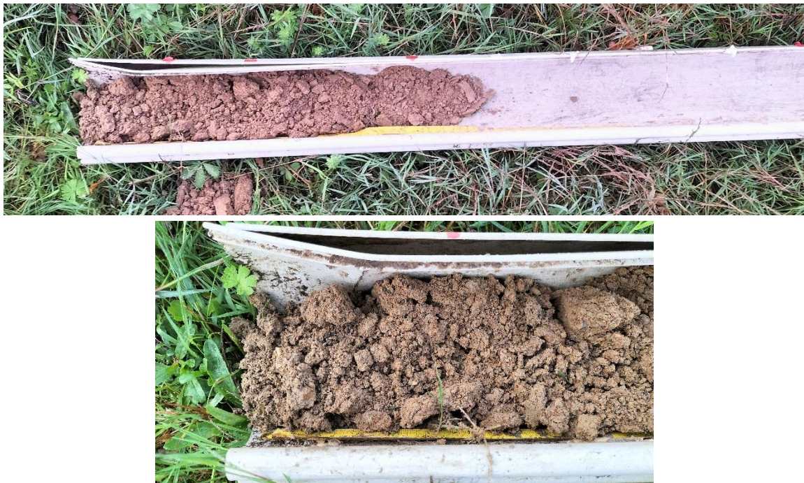
Sondage S4 : REDOXISOL, horizon de surface marqué de traits rédoxiques dès la surface
