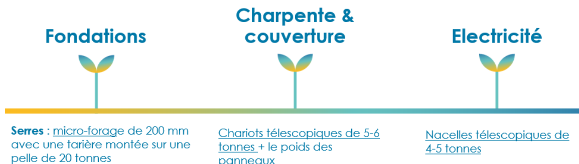
Figure 14 : Les différentes étapes de la phase chantier d'une installation agrivoltaïque chez Technique solaire
