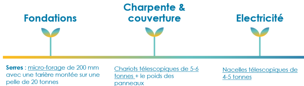
Figure 8 : Les différentes étapes de la phase chantier d'une installation agrivoltaïque chez Technique solaire
