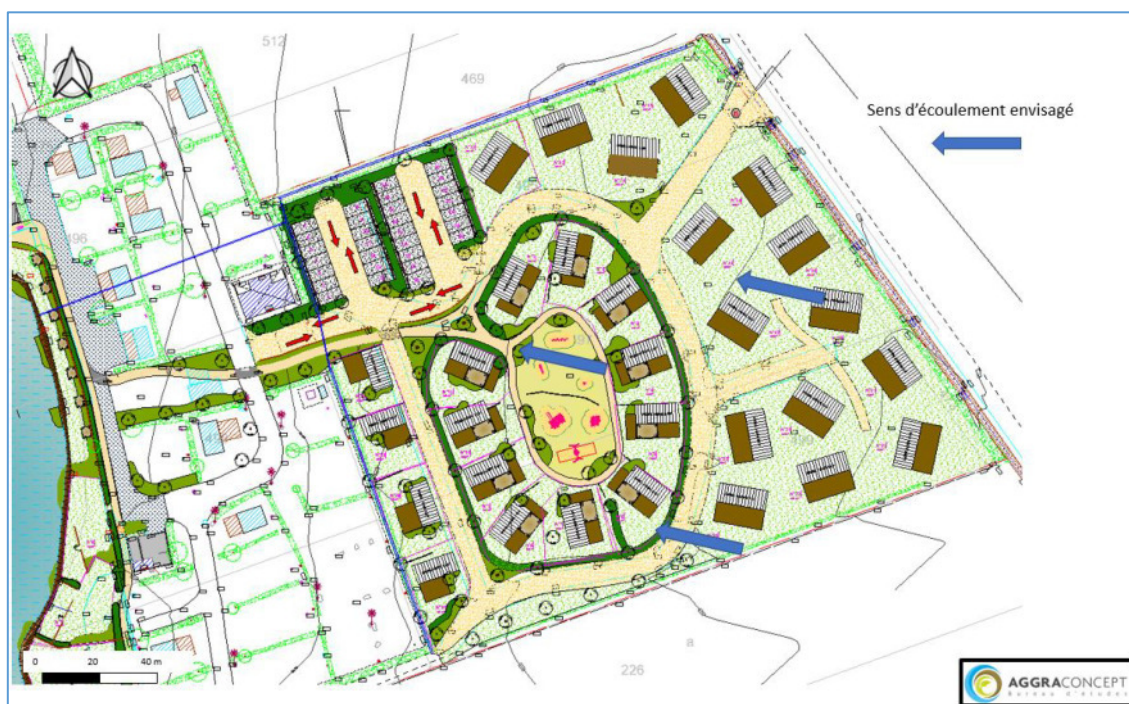
Figure 33 : Plan de la gestion des eaux pluviales futures sur le site de l'extension (localisation des ouvrages et cheminement des écoulements) [AGGRA Concept & Jardins d'Art Home, Aout 2023]
