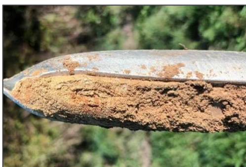
Sondage 1, caractéristique de zone humide (traces d'oxydoréduction dès le début du sondage)
