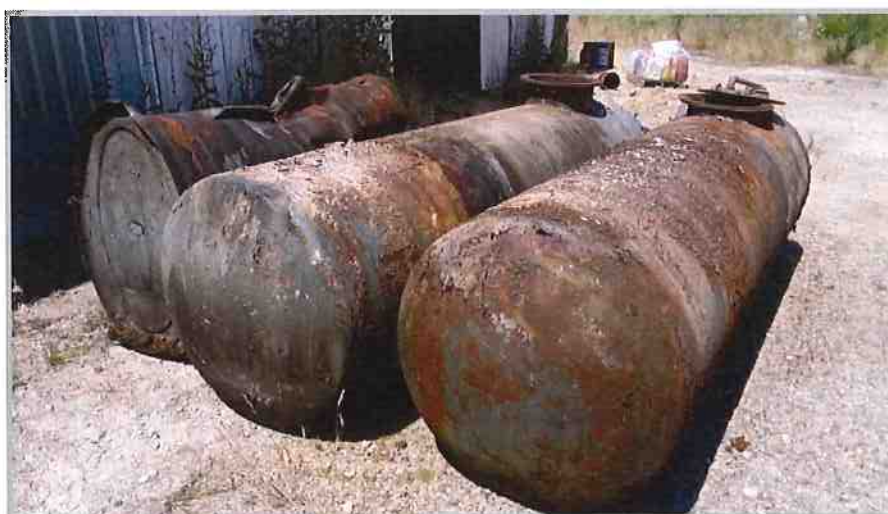
Photo 6 : cuves dégazées en attente d'enlèvement.
