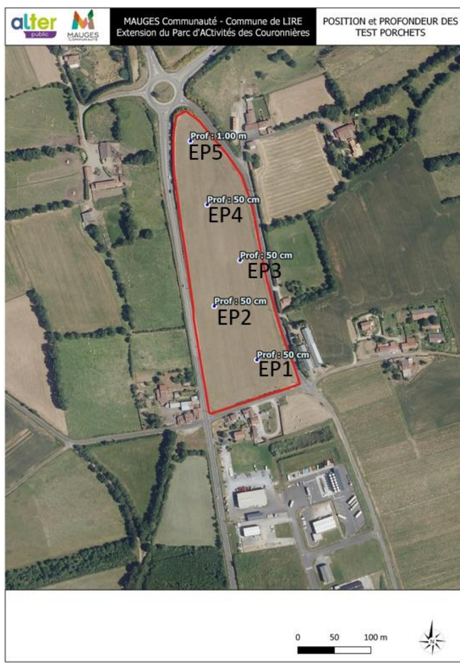
Figure 14 : Localisation et profondeur des tests Porchet
