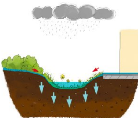
Figure 26 : Schéma d'une noue - © Ville de Villiers-le-Bel
