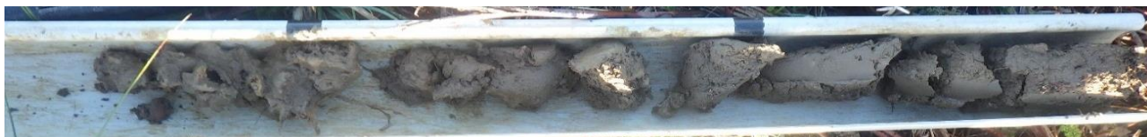
Sondage n°3 : Traces rédoxiques visibles après 25 cm (Classe IVc : non zone humide)
