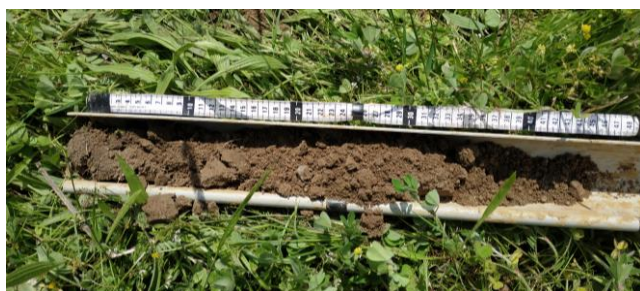
Sondage n°3 : Traces rédoxiques visibles après 25 cm (Classe IVc : non zone humide)
