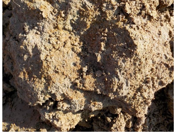
Sable limoneux micro perforé avec trace de marmorisation à partir de -0.4m/TN
