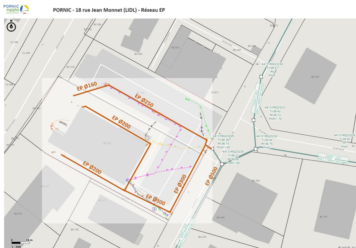
Figure 6 : Réseau EP sur le foncier du LIDL et raccordement au réseau EP communal – source : Pornic agglo
