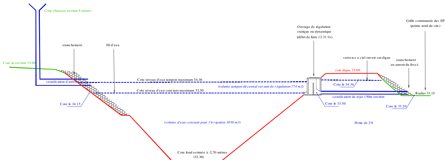
Figure 5 : Coupe transversale des ouvrages de rétention
