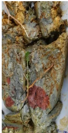
Horizon réductique mis en évidence par l'ortho-phénanthroline
