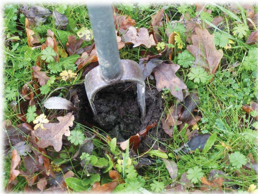
Figure 4 : Blocage de la tarière sur le substrat compact remanié
