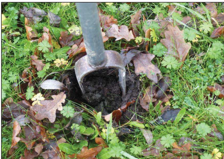
Figure 27 : Blocage de la tarière sur le substrat compact remanié
