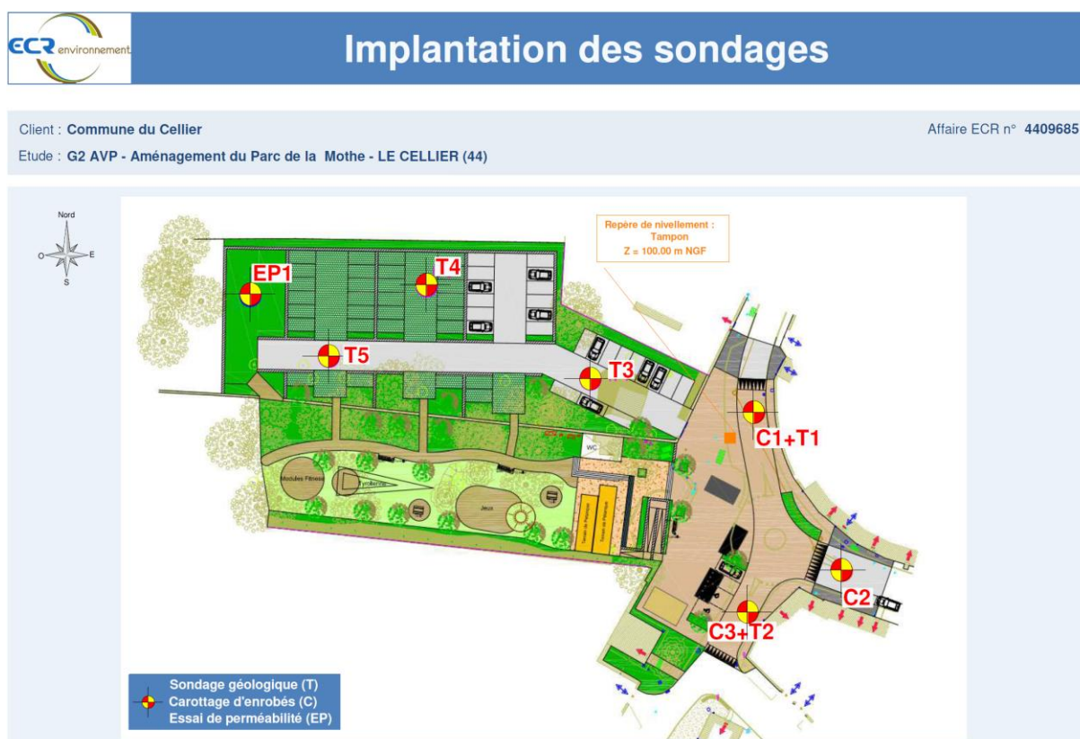
Figure 8 : Implantation des sondages
