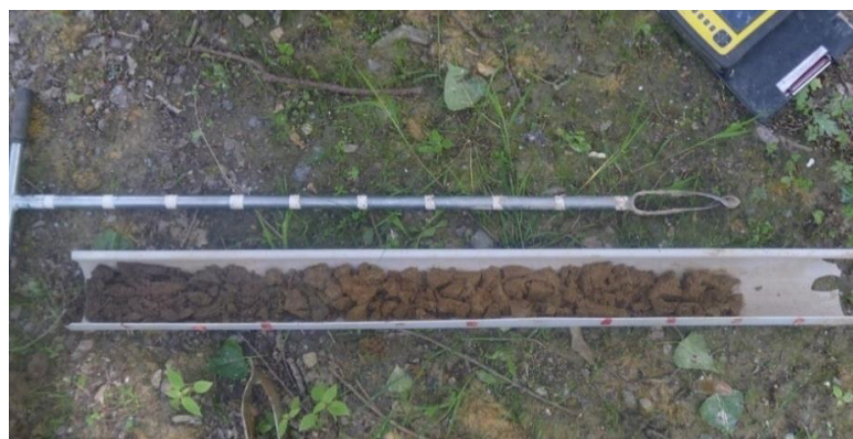
REDOXISOL mis en évidence par le sondage S7
