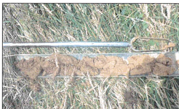
Sondage 15 : présence d'un horizon rédoxique au-delà de 0,25 m (zone non humide).
