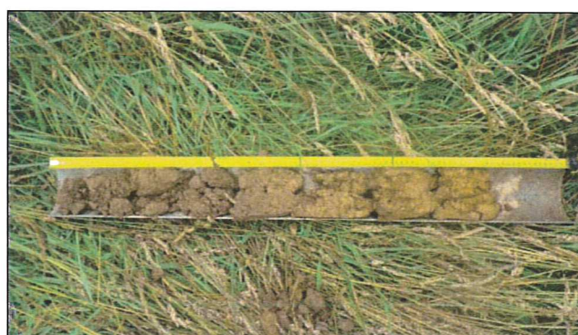
Sondage 23 : présence d'un horizon rédoxique au-delà de 0,25 m (zone non humide).
