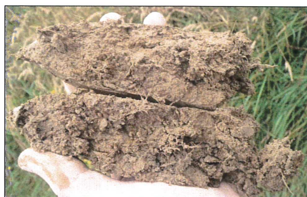
Sondage 26 : présence d'un horizon rédoxique avant 0,25 m (zone humide).
