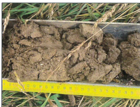
Sondage 25 : présence d'un horizon rédoxique avant 0,25 m (zone humide).
