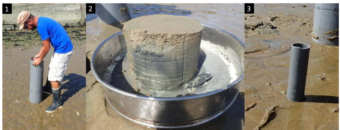
Figure 3 : Prélèvement par carottier de 20 cm de diamètre (1) posé sur un tamis de 1 mm de maille (2). Petit carottier pour l'analyse granulométrique et la teneur en matière organique du sédiment (3).
