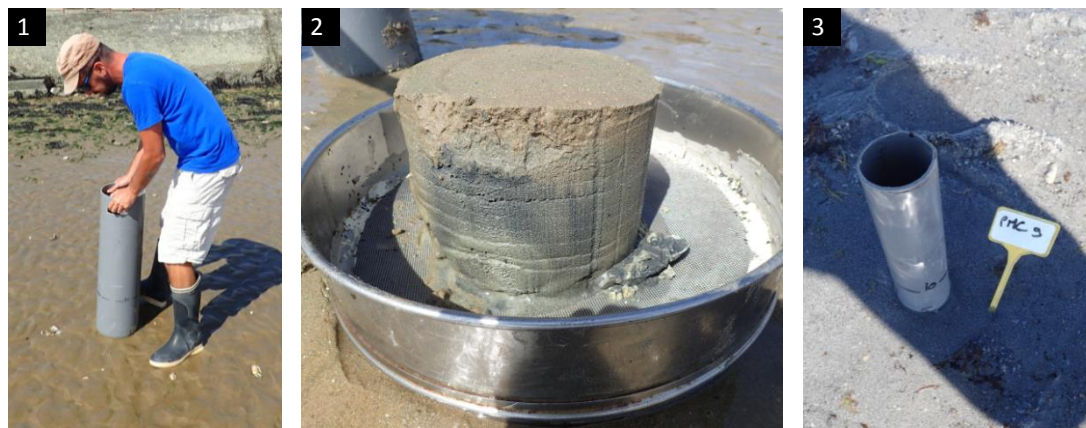
Figure 4: Prélèvement par carottier de 20 cm de diamètre (1) posé sur un tamis de 1 mm de maille (2). Petit carottier pour l'analyse granulométrique et la teneur en matière organique du sédiment (3).
