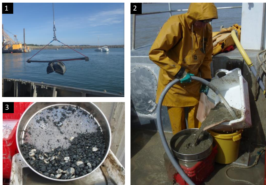
Figure 3: Benne Van Veen (1) et tamisage des échantillons (2). Refus de tamis de maille 1 mm (3) qui sera conservé dans du formol à 3,5-4,5%.
