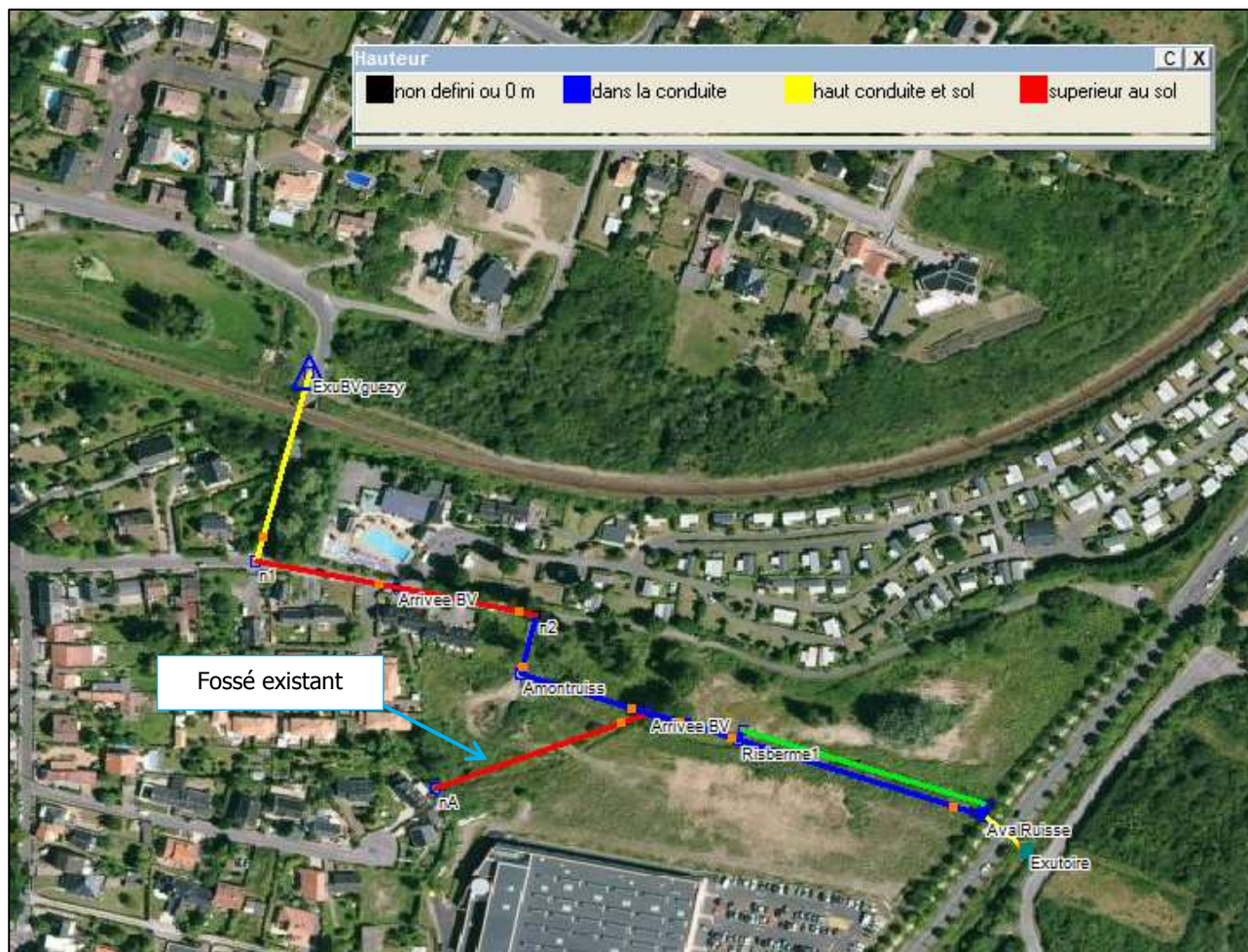
Figure 18 : Les mises en charge du réseau EP en état futur, après redimensionnement en Ø 1000 et création d'un champ d'expansion (pluie centennale – 4 heures)
