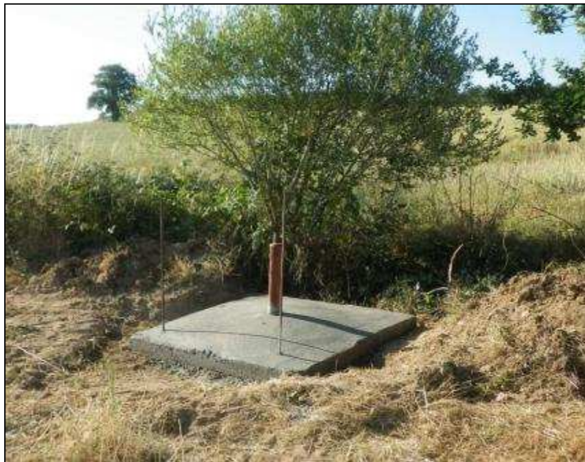
Figure 9 : Illustration de la tête d'un sondage ou piézomètre
