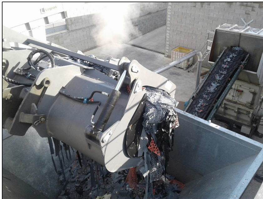
Broyage de la matière première caoutchoutée
