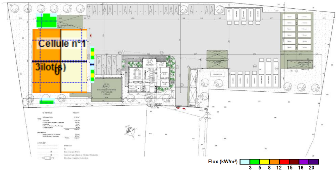
Figure 4 : Zones des effets thermiques de l'incendie généralisé du bâtiment de stockage
