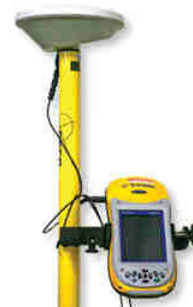
Figure 31 : GPS servant aux levés topographiques
