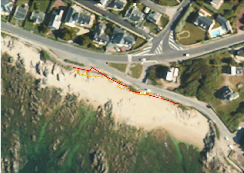
*Illustration 38 – Recul « artificiel » des falaises au niveau de la Baie du Crucifix montré par comparaison des orthophotographies de 2004 et 2009*
