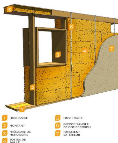
Fig. 5 : Paille structurelle Source : Livret vert « La construction en paille »
