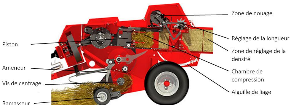
Fig. 26 : Schéma de fonctionnement d'une presse
