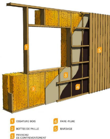
Fig. 2 : Remplissage sur site Source : Livret vert « La construction en paille »
