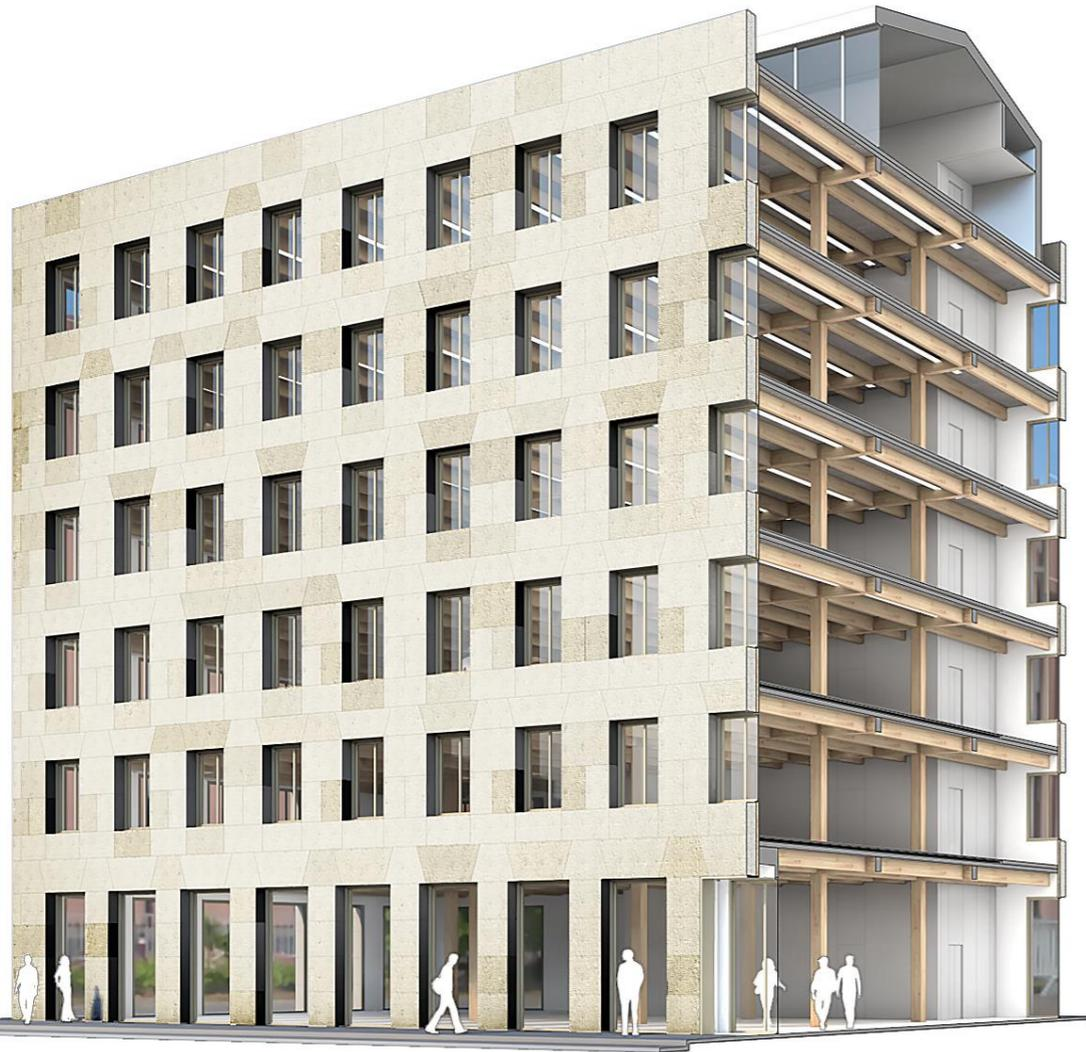
L'objectif est de justifier, par une modélisation aux éléments discrets, un bâtiment R+5 en pierre massive **porteuse**, sans chaînage, sans raidisseur et sans noyau béton.
