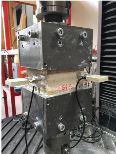
**Essai de cisaillement + compression**
