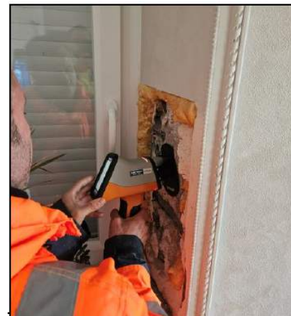
Mesure pXRF sur mur d'habitation de Lépalé
