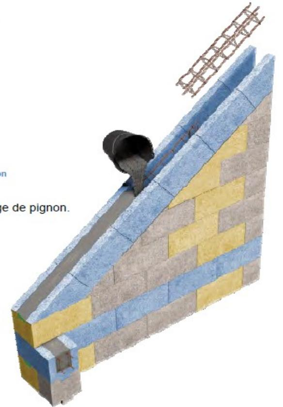
Figure 39 : coulage du béton en chaînage de pignon
