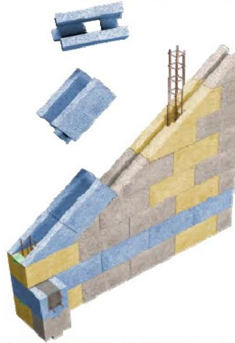
Figure 38 : principe de mise en œuvre des blocs U en pignon
