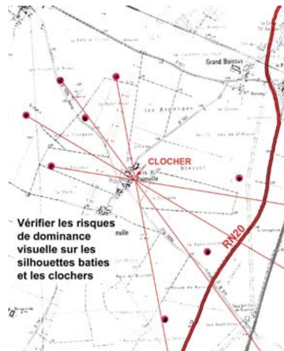
Dans les études préalables à la définition du projet, il est possible de vérifier sur une carte si un problème de dominance visuelle risque de se poser en prolongeant les droites passant à la fois par le clocher et une éolienne, ce qui permet de déterminer les points de vue qui présentent éventuellement un risque
