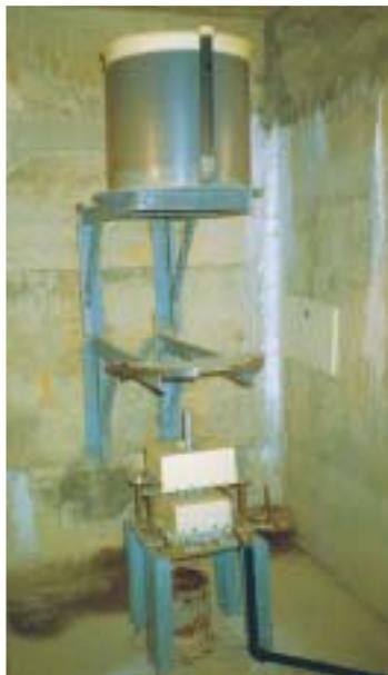
**Photo 10.** Dispositif de mesure d'un pendule inverse.
