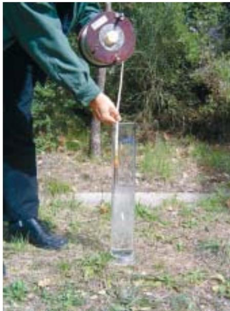
**Photo 5a.** Appareil de mesure piézométrique.
