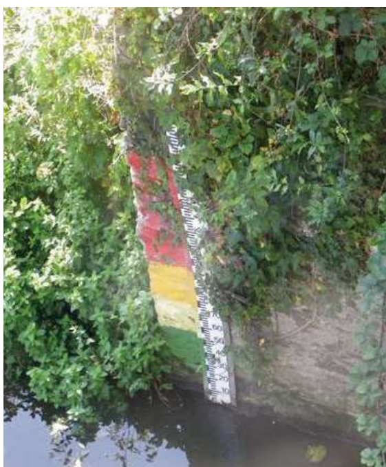
Exemple de marquage sur une échelle limnimétrique ©SCSOH Pays de la Loire
