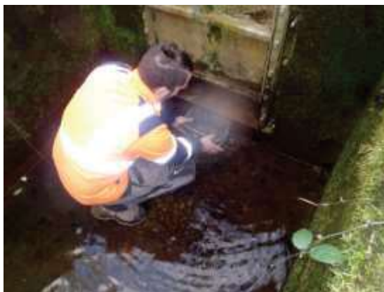
Mesure d'un débit de fuite de la vidange de fond – Barrage de la Verte Vallée (22) ©DREAL Bretagne Oliver ORHANT – octobre 2021
