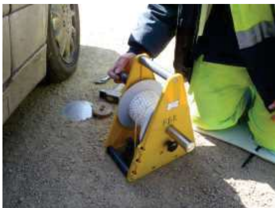
Mesure d'un niveau piézométrique par ruban Barrage de Châtaudren (22) ©DREAL Bretagne Olivier ORHANT – mars 2021
