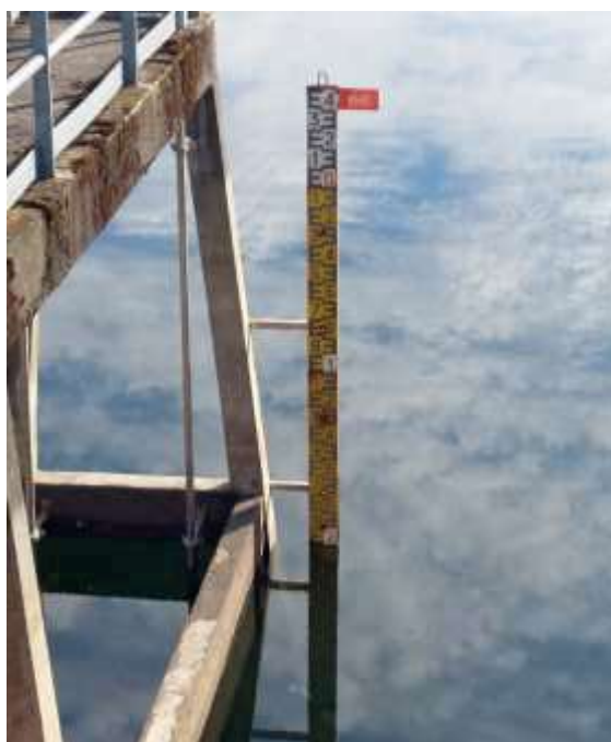
Échelle limnimétrique du barrage de la Crouzille (87) avec repérage de la cote des plus hautes eaux (PHE) © PoNSOH – Hélène CHITRY
