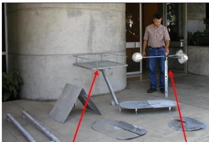
*Figure 39 : Plateforme portugaise et anémomètre (RTE)*
