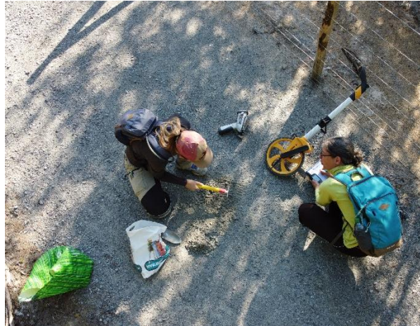
Figure 6 : Préparation du sol et mesures pXRF sur le chemin mis en sécurité.
