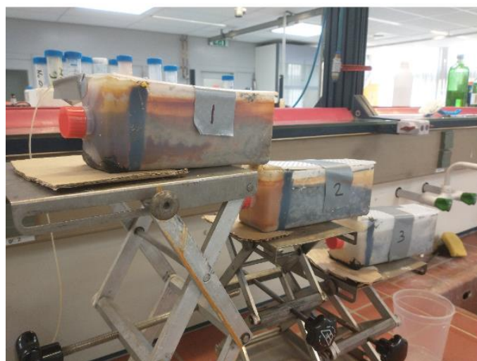
Figure 4 : Essais de traitabilité du DMA à l'échelle laboratoire (source : Tauw)
