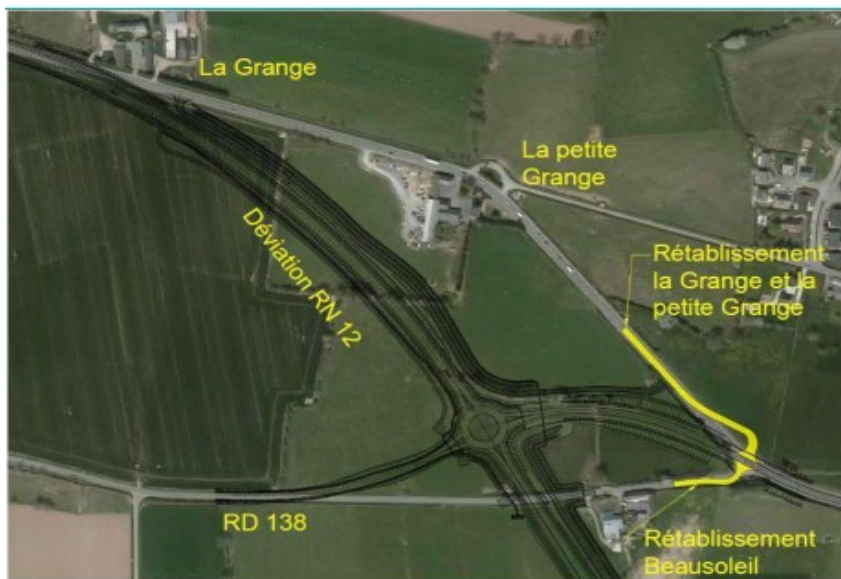
RÉTABLISSEMENT DES ACCÈS RIVERAINS
