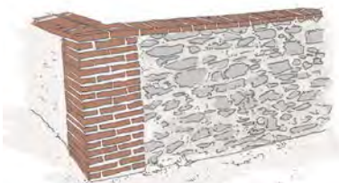
Couvrement de briques plates
