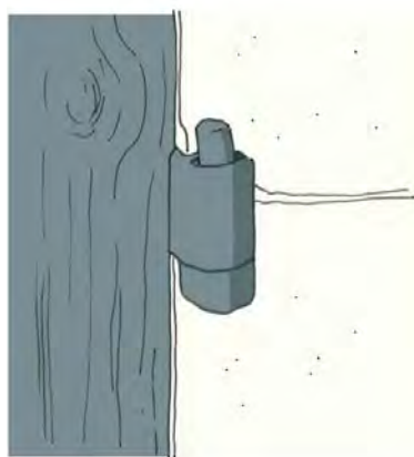
Gond scellé dans la maçonnerie
