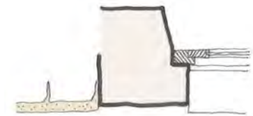
Mauvais exemple : Enduit en surépaisseur par rapport à la pierre de taille
