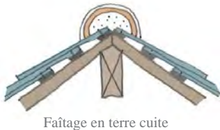
Faîtage en terre cuite
