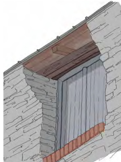
CORNICHE DE MOELLONS :
