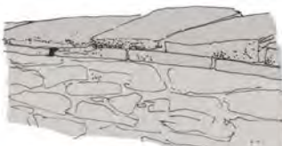
Couvrement pierres plates
