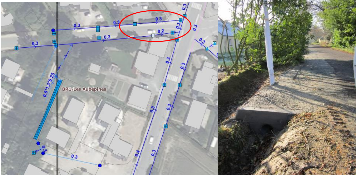
Figure 4 - Fossé busé en sortie du bassin des Aubépines
