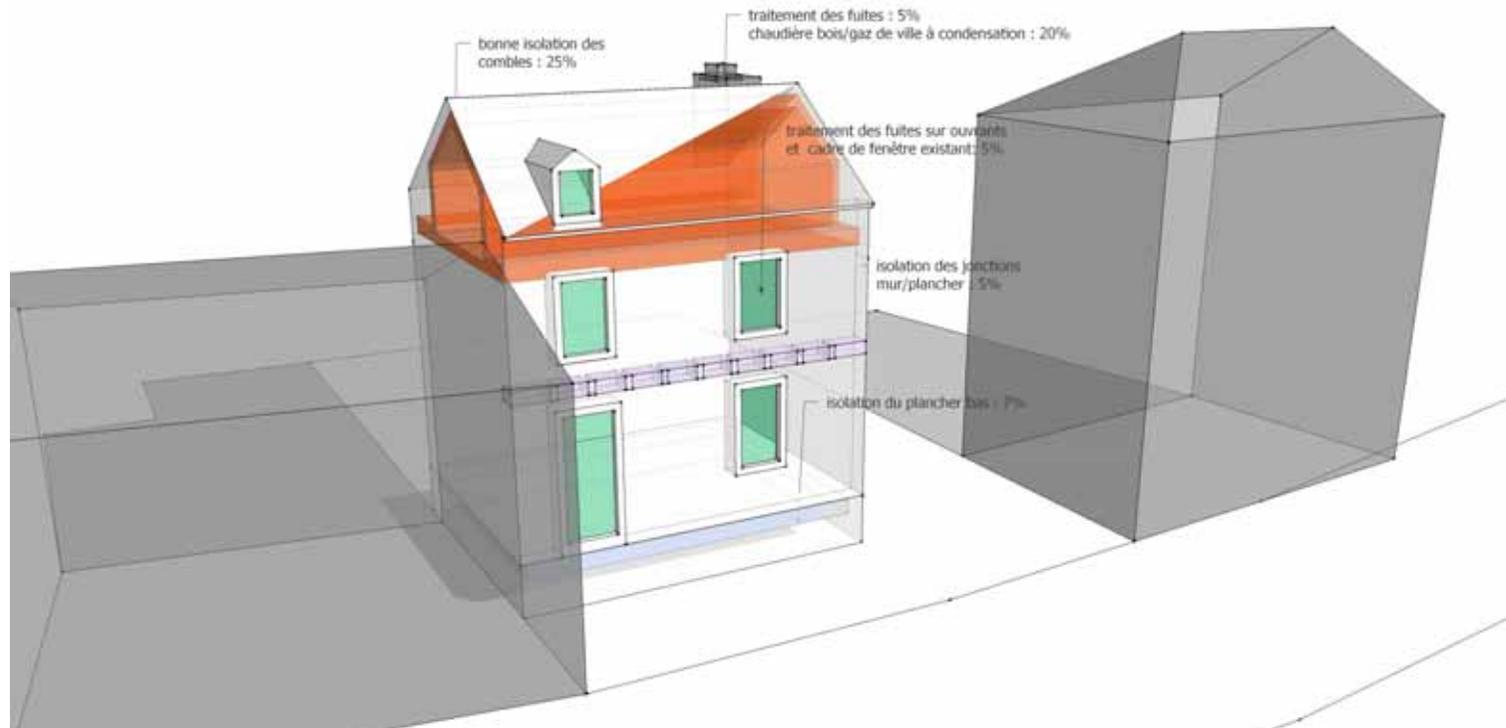
Hypothèse A : isolation de la toiture, des planchers, et traitement des fuites d'air (menuiseries anciennes non jointives, cheminées non fermées, percements des façades, cave etc) par calfeutrement simple et bonne calibration d'une VMC existante pour contrôler le renouvellement de l'air.
