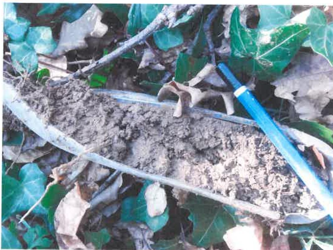
Figure 6 : Horizon pédologique remarquable. Sol végétatif superficiel (terrain de 0 à 0,80 m) : Limons fins et moyens sableux à cailloutis centimétriques de quartz roulés. Photo reproductible pour les sondages de ST1 à ST08.
