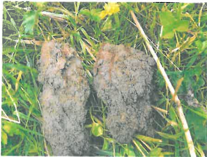
Traces de couleur rouille, caractéristiques de réactions d'oxydation
