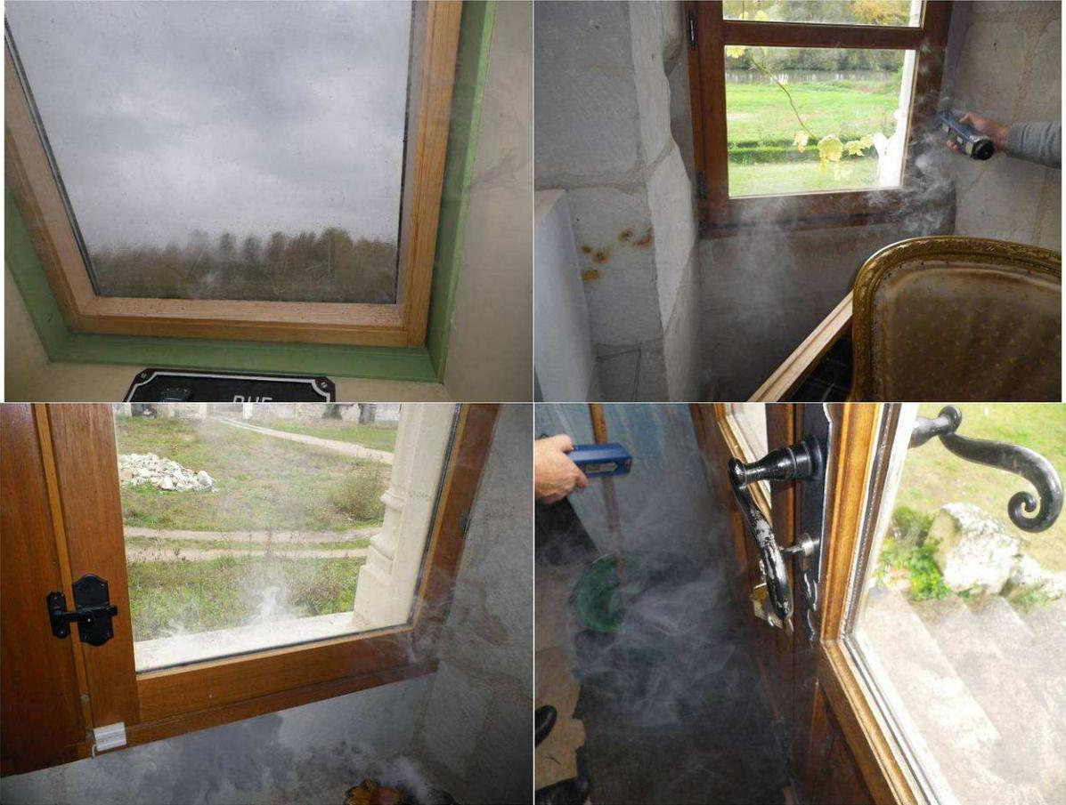
Figure 3-3 : Fuite entre dormant-ouvrant et dormant-mur au droit de plusieurs menuiseries (notamment dans la cuisine)
