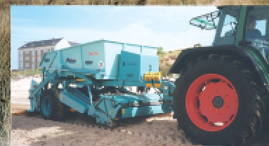
Le nettoyage mécanisé des plages est réalisé grâce à des engins spécialisés. Il offre l'avantage de "laine de mer" et ne permet pas la fin des déchets.
